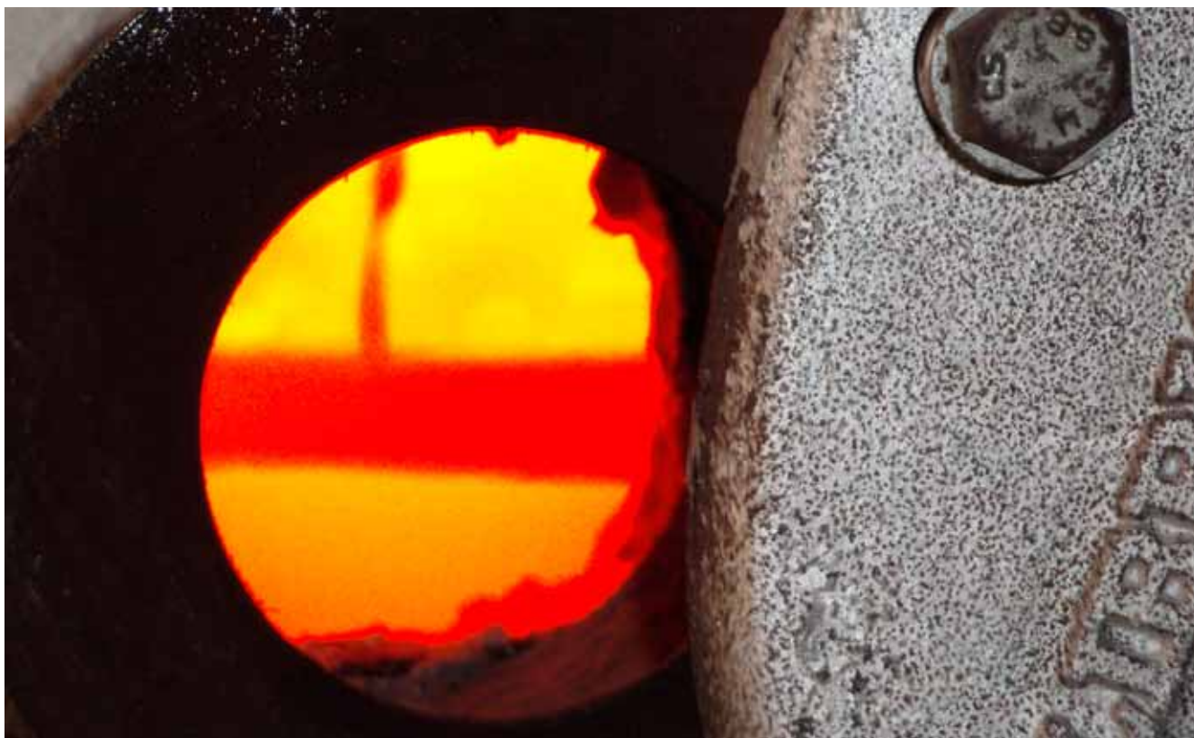
Förbränning av ren energigas i 500 kW-anläggningen i Köping.
